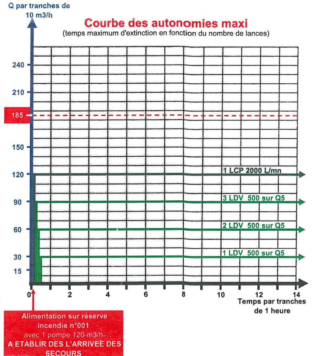
**⚠ Il est possible d'augmenter les possibilités hydrauliques de 120 m<sup>3</sup>/h par l'établissement d'une 2<sup>ème</sup> MPR 120 m<sup>3</sup>/h sur la réserve incendie n°001.**
